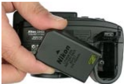
La Coolpix 8400 funziona con la medesima tensione della 5400: 7.4v ma l'ampereaggio della batteria a corredo passa dai 780mAh della 5400 ai 1.100 mAh della 8400, portando l'autonomia di scatto a 260 scatti in base agli standard CIPA.
