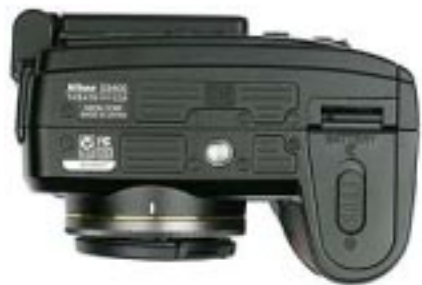
Sul fondo della macchina l'attacco filettato per il treppiede e il vano portabatteria.
