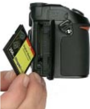
La Coolpix 8400 accetta CompactFlash di tipo I e II oltre al Microdrive: qui la vediamo con la CF SimpleTech da 256MB in dotazione con la fotocamera.
