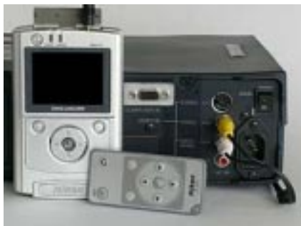
Il coolwalker collegato alla presa AV di un videoproiettore; attraverso il telecomando fornito in dotazione è possibile eseguire impeccabili audiovisivi, così come presentazioni di immagini o di diapositive estrapolate da un file Power Point.
