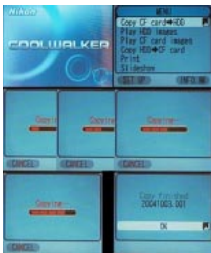
Una volta inserita la CF nel Coolwalker è possibile visionare le immagini o copiarle; durante la copia una barra in progressione evidenzia il tempo restante al completamento della copia dei dati.
