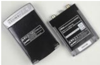
Sfilando la parte inferiore del Coolwalker si accede al vano batteria che accetta la batteria proprietaria EN-EL6 Nikon da 2000 mAh 3,7V in grado di alimentare il coolwalker per 1,5 ore.
