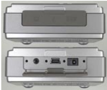
Le prese AV, USB e per il collegamento all'alimentazione esterna.
