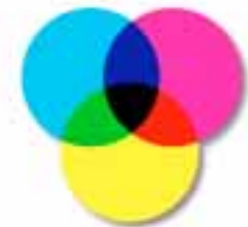
Sintesi sottrattiva CMYK di una stampante ink-jet
