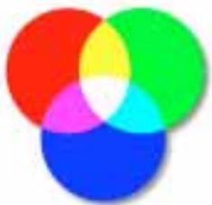
Sintesi additiva RGB di un monitor CRT
