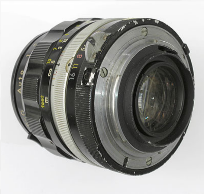
Una baionetta F artigianalmente modificata in AI, questa vecchia ottica Nikon ha un innesto compatibile anche con la Nikon D40
