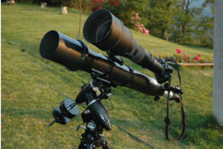
Collegata in parallelo al telescopio la D70 con l'800mm per astrofotografie al cielo profondo – a campo relativamente largo -.
