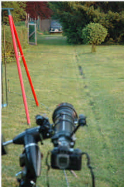
Collegata in parallelo al telescopio la D70 con l'800mm per astrofotografie al cielo profondo – a campo relativamente largo -.
