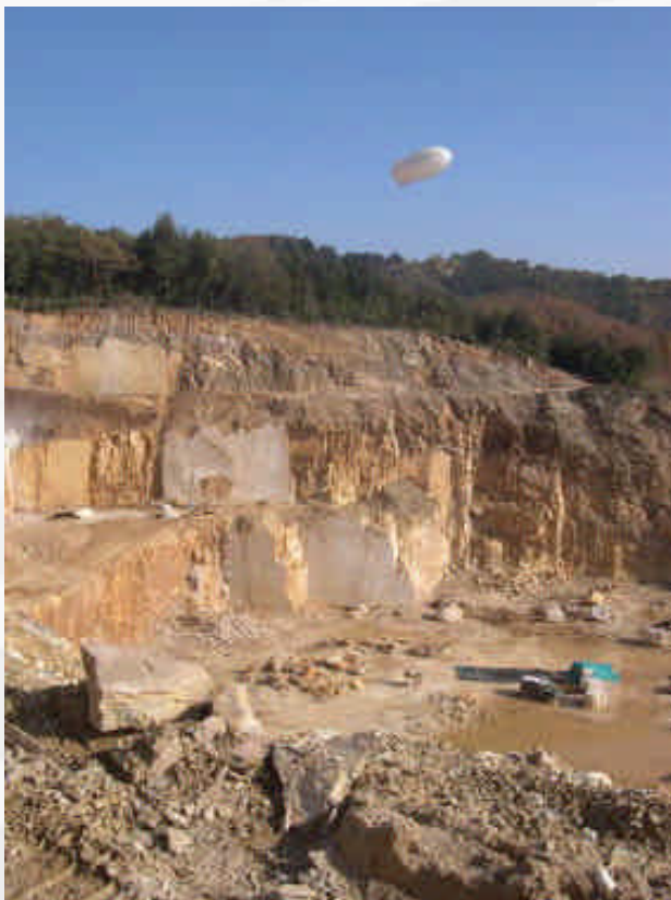
Il dirigibile fissato sul sito con tre ancoraggi pronto per realizzare le coppie di stereofotografie eseguite dalle Coolpix 3100.
