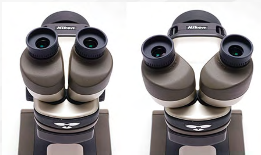
La regolazione della distanza interpupillare degli oculari.
