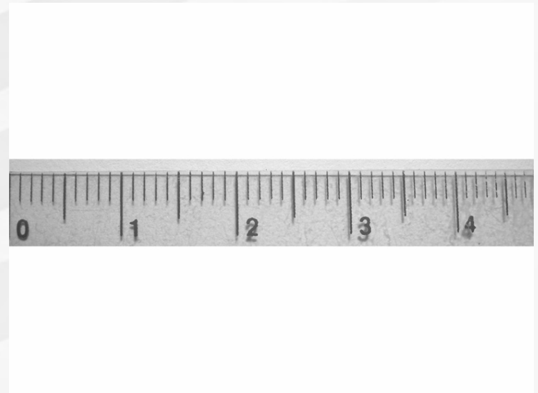
Nikon Coolpix P5000 alla minima distanza di messa a fuoco: la base dell'area inquadrata è di 47mm.
