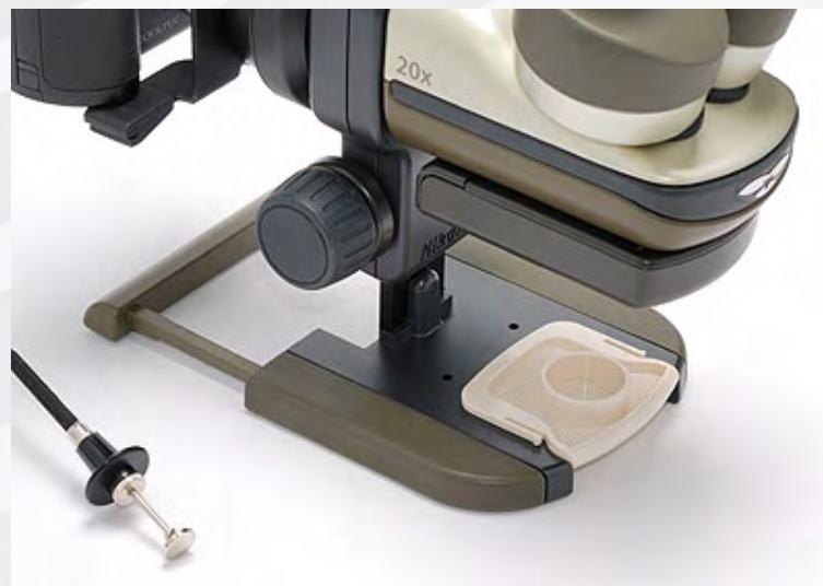
Invertito di 180 gradi il portaoggetti presenta una cavità adatta all'osservazione di liquidi, come qualche centilitro di acqua di uno stagno, alla ricerca di piccoli organismi, che potranno essere osservati, fotografati e, con fotocamera come la P5000, anche filmati.
