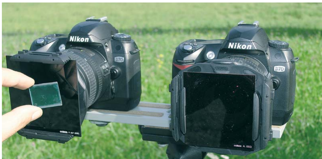
A sinistra la Nikon D70 "elaborata" da LTR che ha rimosso il filtro al niobato di litio, a destra la Nikon D70 "normale",
