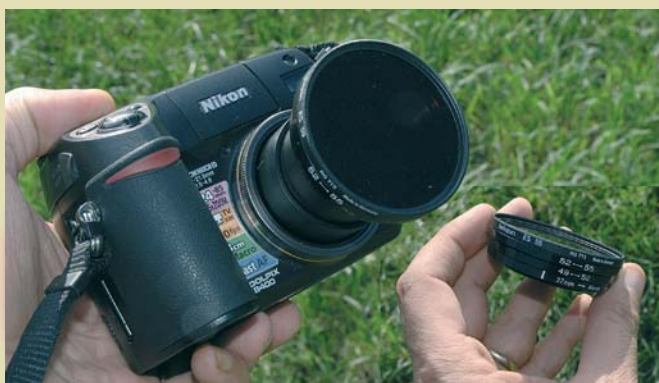
La Coolpix 8400 con il filtro Heliopan Infrarot 715 che è stato montato direttamente sulla filatura dello zoom della fotocamera, utilizzando alcuni anelli di riduzione.
