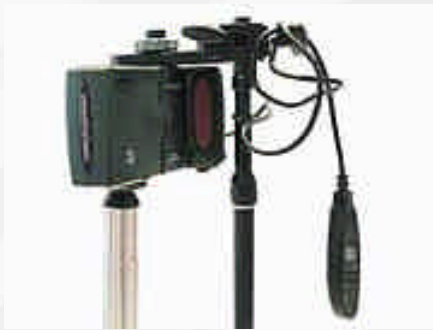
La Coolpix sul microscopio: si tratta di un Meopta da campo. Per posizionare l'obiettivo della Coolpix sull'oculare del microscopio in questo caso abbiamo utilizzato il treppiede da tavolo Manfrotto 209 con prolunga 259B
