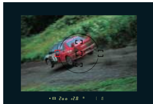
AF ad Area Dinamica: il soggetto rimane a fuoco anche se esce dall'area selezionata: l'area attiva scorre automaticamente a seguire il soggetto
